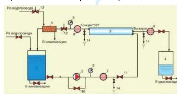
**Рис. 3.** Схема экспериментальной установки очистки воды с
