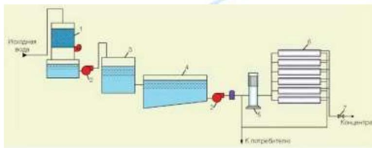
**Рис. 1.** Технологическая схема применения установок обратного осмоса, применяе- мая для очистки подземных вод:
