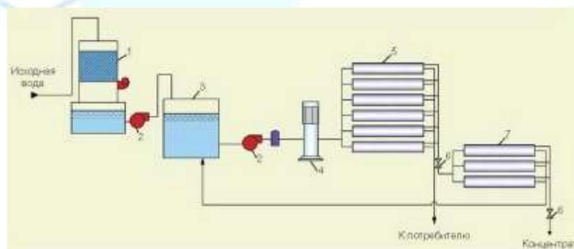
**Рис. 2.** Технологическая схема очистки подземных вод с применением метода
