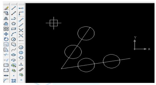
Команда «Линия» загружается левой кнопкой мыши. Для их скругления дугой окружности проводят параллельные им прямые на внутренних сторонах угла на расстоянии радиуса скругления R и пересекают их. Затем формируется точка соединения центра 0. Из центральной точки 0 проводят перпендикуляр к сторонам угла под углом 90° и находят точки соединения A и V (рис. 3).
