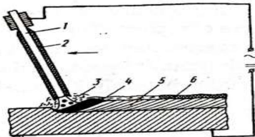
Yoyli dastakli payvandlash chizmasi: 1- elektrod o'zagi; 2- elektrod qoplamasi; 3-gaz yoki gaz-shlak himoya; 4-payvandlash vannasi; 5-payvand chok; 6-shlak qoplamasi.
