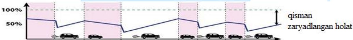
3-rasm. Stop-start tizimiga ega avtomobilning ekspluatatsiyasi jarayonida AKB si zaryadlanish darajasi grafigi [6].
