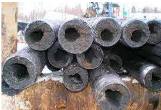
1-rasm. Vodorod sulfidli korroziya mahsuloti va mexanizimi
