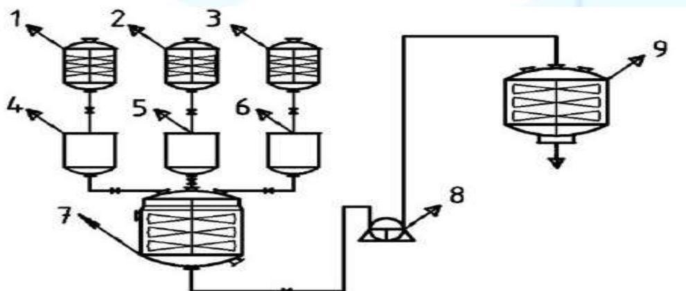
1 – расм. Гидрофоб қурилиш материаллари олишнинг принцинал технологик схемаси. 1,2,3 реагентларни сақлаш учун сиғимлар, 4,5,6 ўлчовчи дозатор идишлар, 7 гидрофоб композиция ҳосил қилувчи реактор, 8 насос, 9 қурилиш қорихмали аралаштиргич.
