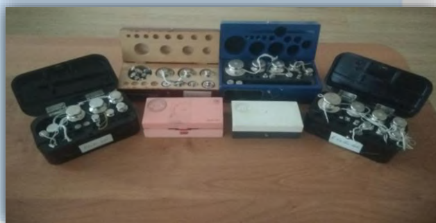
Рис.1. Гири для определения массы, необходимой для обрыва сцепленных летучек хлопка
