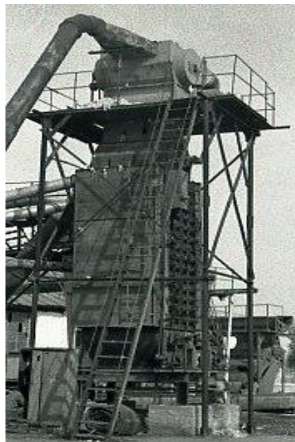
1-расм. Юқори навли пахтани қуритиш ва тозалаш ускунасининг схемаси ва умумий кўриниши
