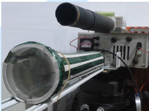
Рис.1. Конструкция и физическая модель исследуемого приёмника на базе многокаскадного усиления.
