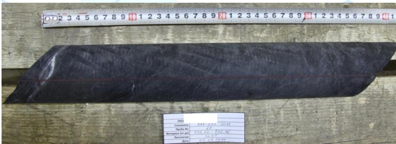
Пример образцов для испытаний UCS+UTS
