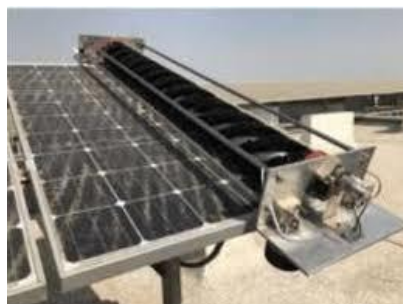
1-rasm. Oʻzini-oʻzi tozalovchi va poylash tizimiga ega quyosh fotoelektrik stansiyasi.
