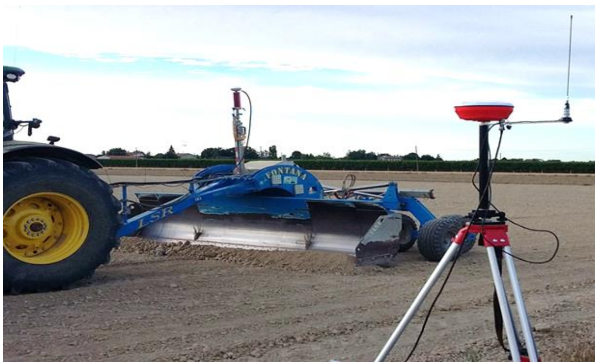
2-rasm. Yerlarni lazer niveliri yordamida tekislash.
