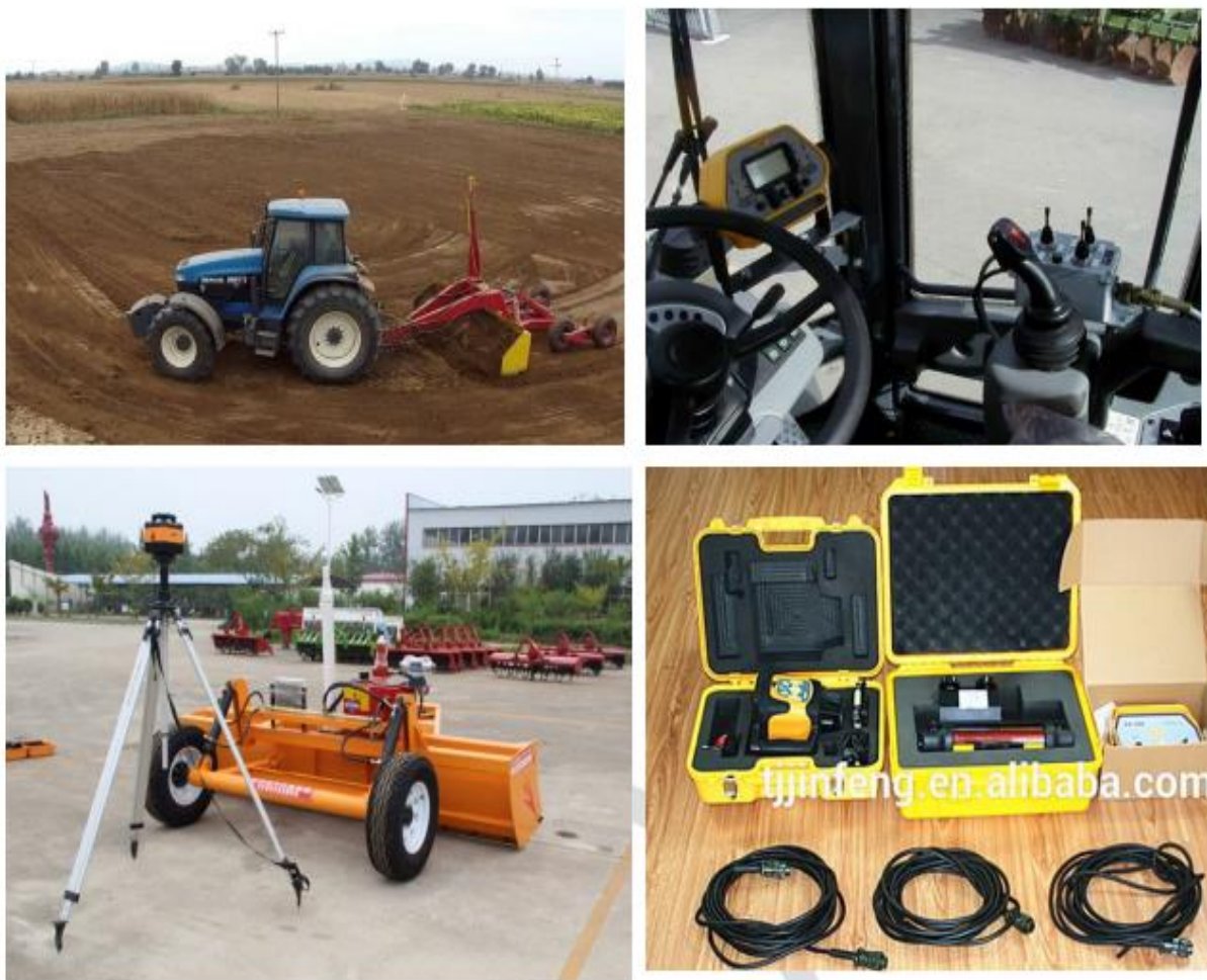
3-rasm. Lazerli yer tekislagich va uning qurilmalari
