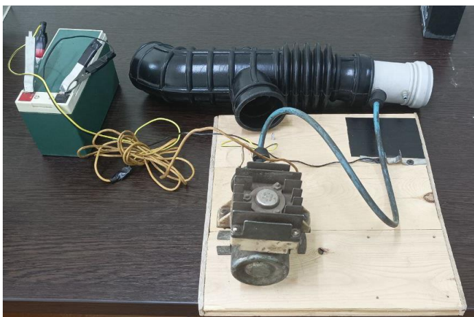
1- расм. Озонаторнинг тажриба намунаси
