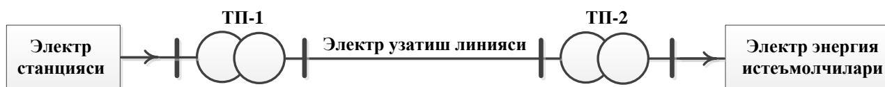
1-rasm. Elektr energiyasini ishlab chiqish, uzatish, taqsimlash va iste‘molining bir chiziqli elektr ta‘minot sxemasi
