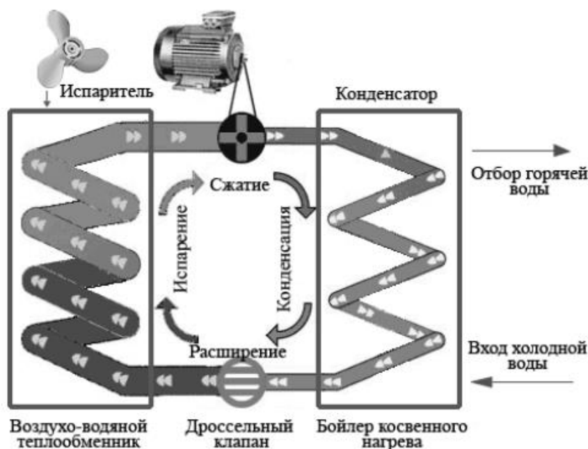
Рис.1. Принцип действия теплового насоса
