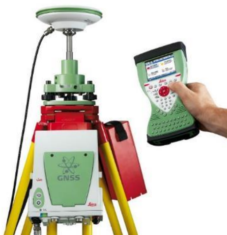
1-rasm. Leica GS-10 markadagi to'liq qabul qilgich qurilmasi
