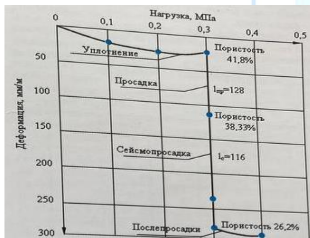
Рис. 1. График зависимости деформации лессового грунта от нагрузк Начальная пористость 46,7%. Ускорение колебания 3000 \text{ wwle}^2
