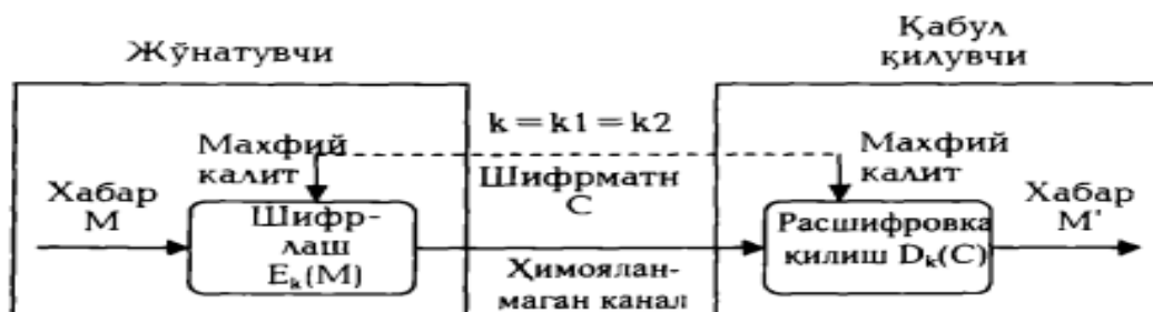
B-rasm. Simmetrik shifrlash kriptotizimning sxemasi
