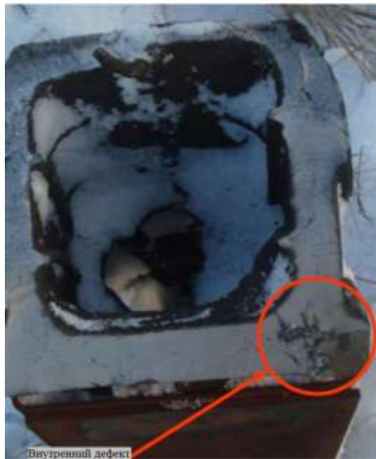
Рисунок 3 – Излом боковой рамы с внутренним литейным дефектом
