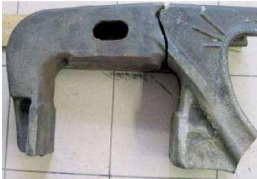
Рисунок 2 – Излом боковой рамы по внутреннему углу буксового проема
