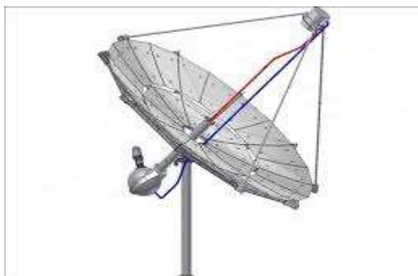
1-rasm. Stirling dvigatelini yurgizishda Quyosh konsentratori fokusiga issiqlik tashuvchi suyuqlik joylashtirish sxemasi
