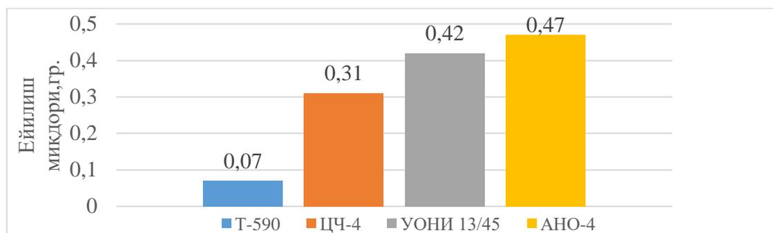
**1-rasm.** Elektrodlar markalariga qarab payvandlab qoplangan namunalarning yeyilish miqdorlari.
