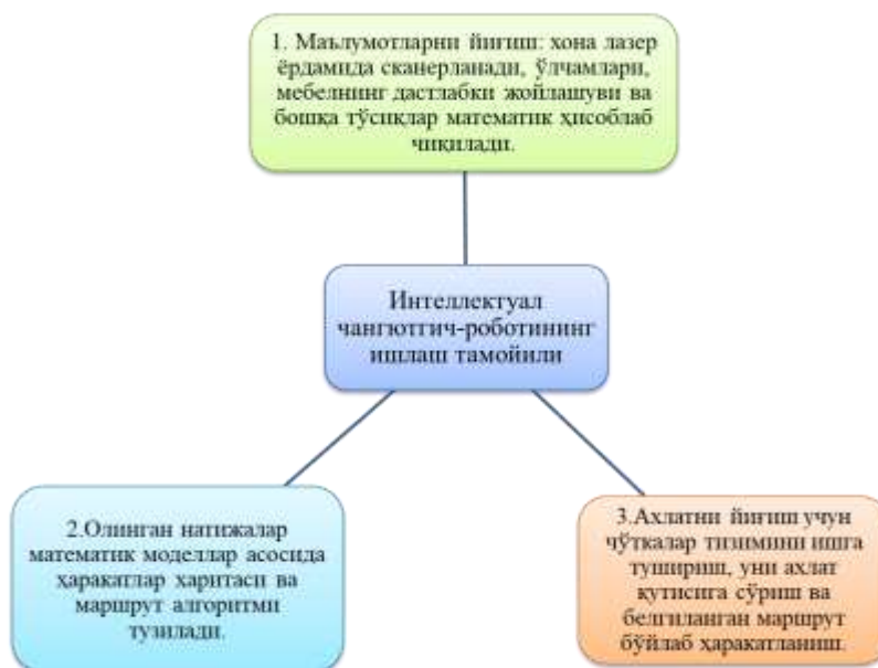
1-Расм. Интеллектуал чангютгич роботининг ишлаш тамойли
