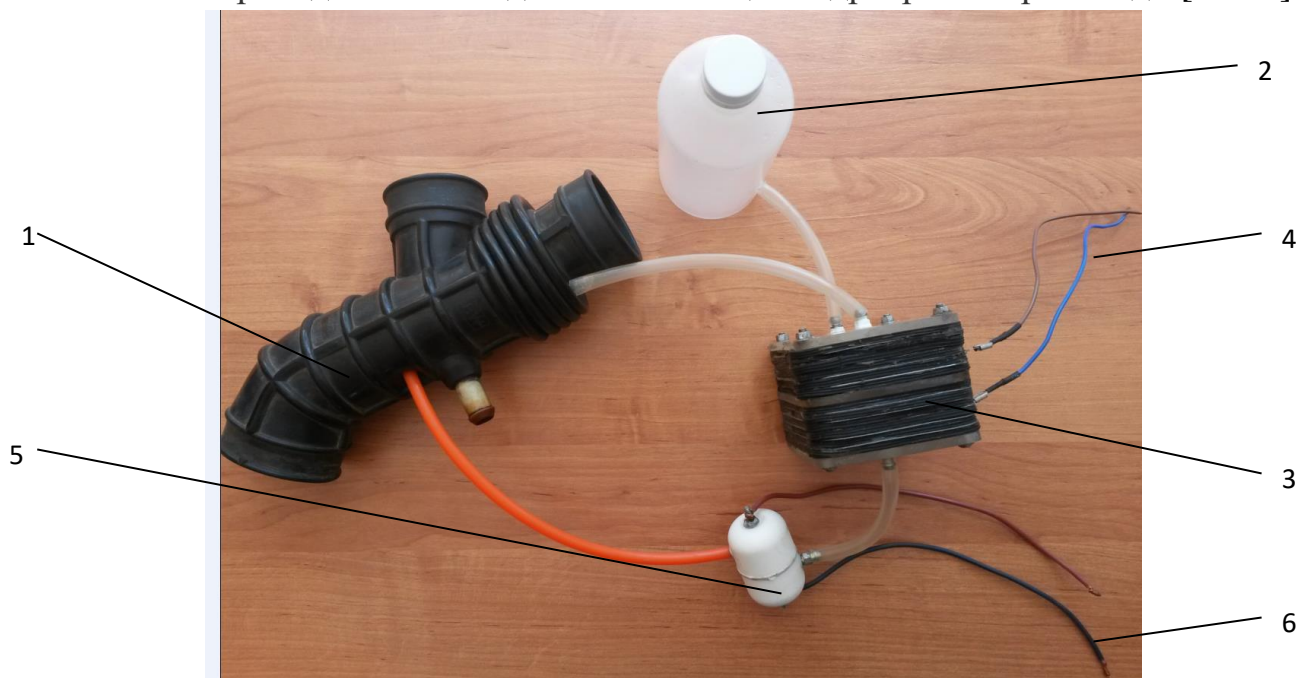
2- расм. “Нексия” автомобили учун ясалган водород генератори: 1- ҳаво шланги; 2- сув баки; 3- электролизёр; 4-12 В ли токка улаш симлари; 5- озонатор; 6- 30 кВ ли токка улаш симлари.
