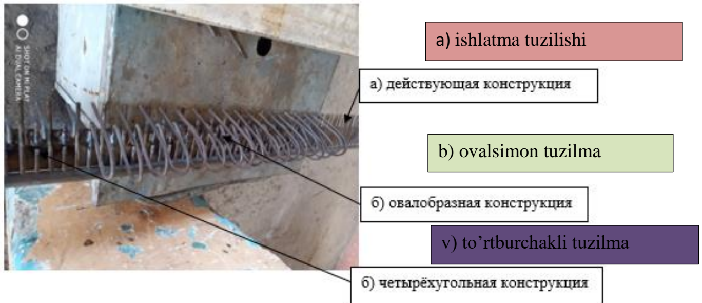
Shakl 1. Modernizatsiya qilingan urug 'taragi dizaynining umumiy ko'rinishi.
