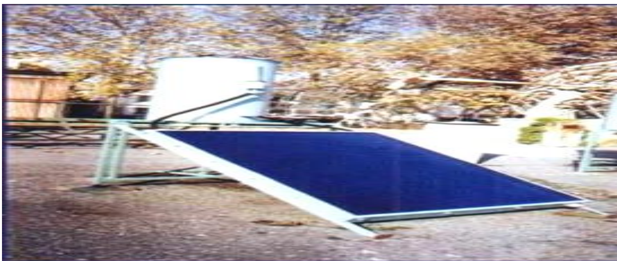
1-расм. Қуёш иситгичининг сатҳи 2 м 2 ва иссиқ сув жамловчи бакининг ҳажми 140 л бўлган 2 контурли сув иситгич қурилма
